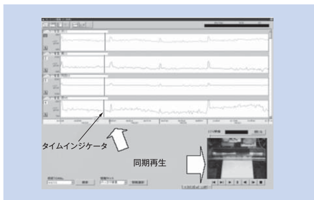
図2 「HITSODAS」プレイバックシミュレータの画面例 チャートと映像の同期再生により、プラント解析を支援する。
