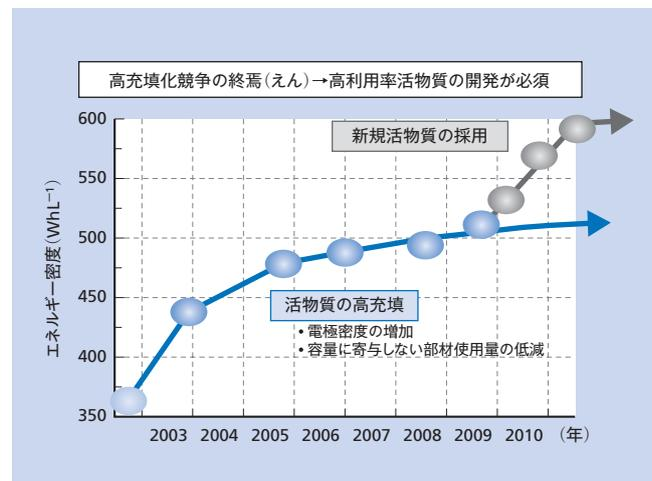
図1 | 角形リチウムイオン電池のエネルギー密度推移
