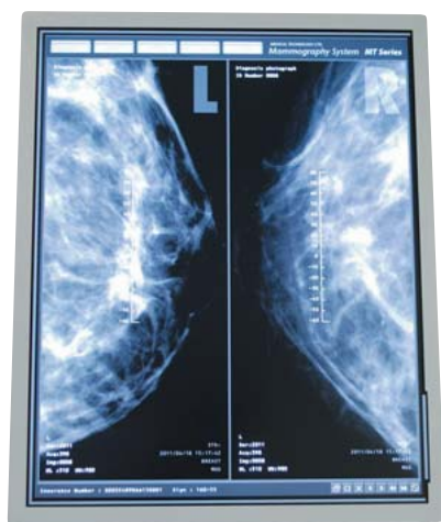
1 医療用21.3形高精細（500万画素）モノクロ液晶モジュール（マンモグラフィ表示例）
