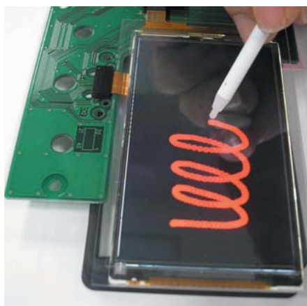
2 ペン入力対応静電容量タッチパネルの動作例
