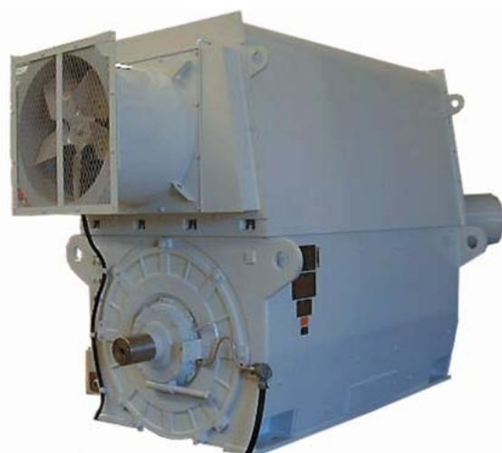
3 ダウンウィンド型2 MW風力発電システムのナセル部 (左) と全閉型発電機 (右)
