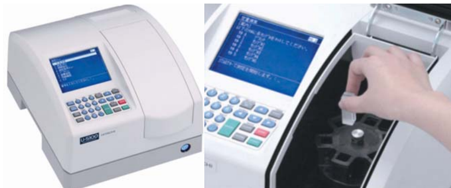
1 分光光度計U-5100の外観(左)、自動6セルターレット(右)
