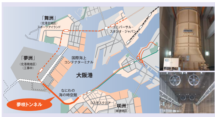
21 夢咲トンネルの位置（左）、軸流ファンとジェットファンの外観（右）
