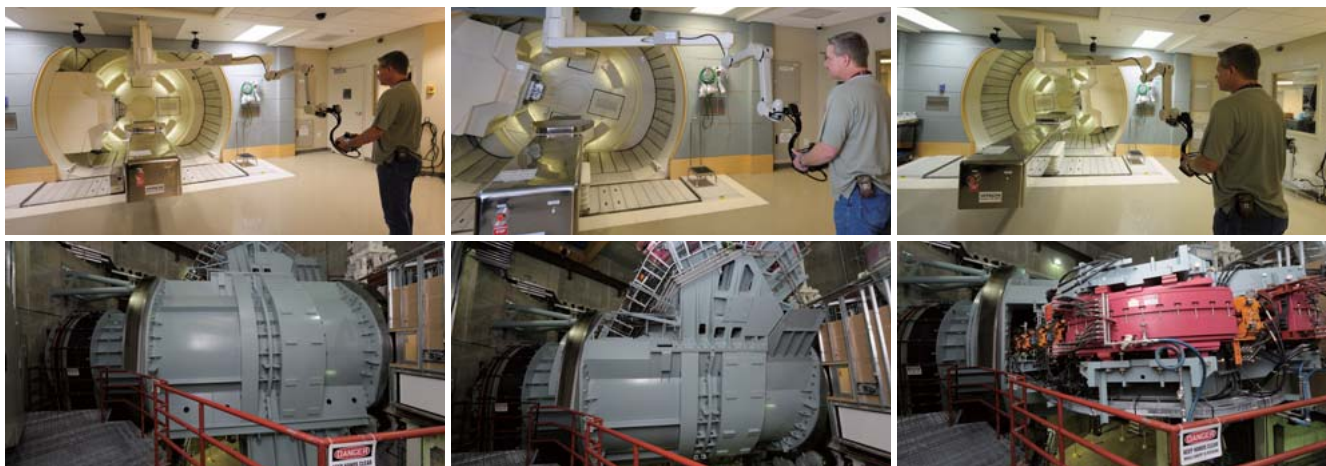
回転ガントリーを用いることで、身体の全周位から陽子を照射できる。各治療室の裏に配された装置が治療台を回転させる。
