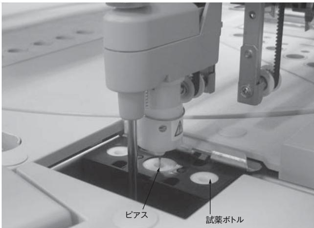
図8 | 蒸発防止試薬ボトルとピアス機構
