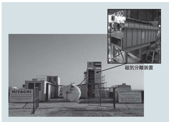
図6 | アラビア湾内に設置した赤潮除去設備 処理能力400 m 3 /hの設備は、20フィートコンテナ4台に設置し、移動しやすくした。
