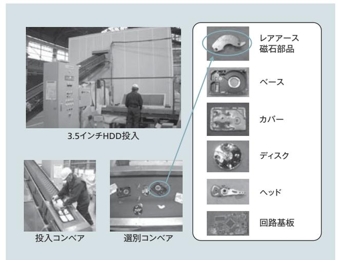
図3 | HDD分解装置の概要
