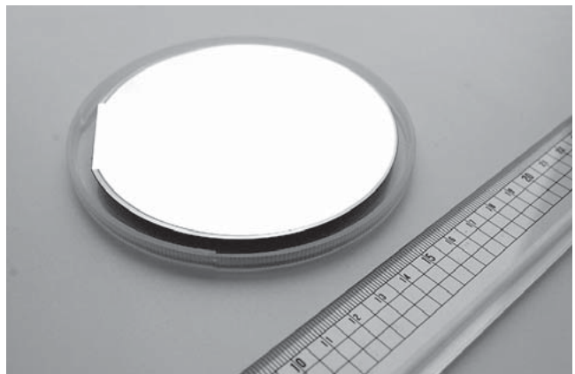
図7 | 4インチ径シリコン基板上に製膜した (K, Na) NbO 3 圧電薄膜 スパッタリング法により高c軸配向かつ低残留応力を実現し、世界で初めて実用レベルの鉛フリー圧電膜の開発に成功した。
