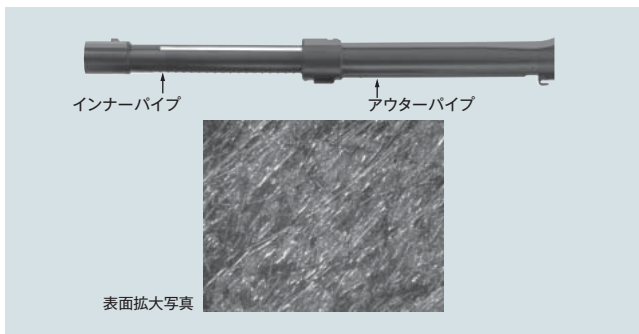
図3 | カーボン繊維強化プラスチックを採用した延長パイプ インナーパイプとアウトターパイプにカーボン繊維強化プラスチックを採用することで、強度を確保したまま肉厚を薄くし、軽量化を図った。
