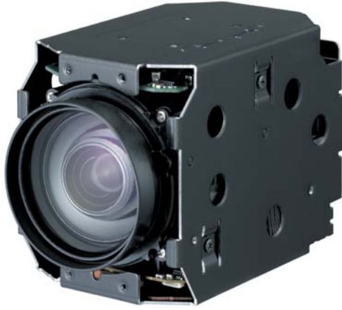
8 2.1 Mピクセル相当の監視カメラモジュール「DI-SC220-C」
