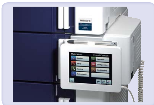
1 タッチパネルを採用した新規コントローラ
