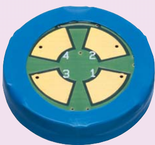
1 コイン形リチウム二次電池ユニットの外観(左)、一円玉とのサイズ比較(右)
