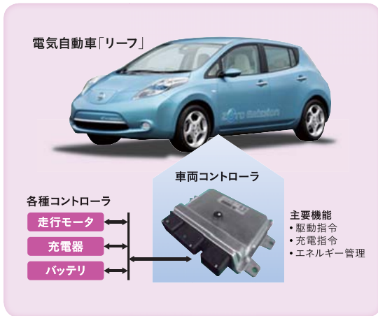
2 電気自動車用車両コントローラ
