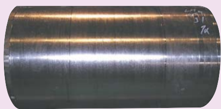
1 開発材の直径800 mm大型鋳塊
