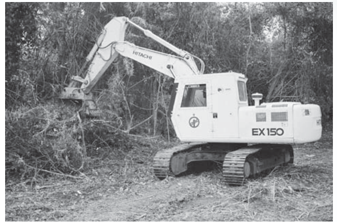
図2 | ロータリーカッターで効率よくブッシュを処理する旋回式対人地雷除去機
