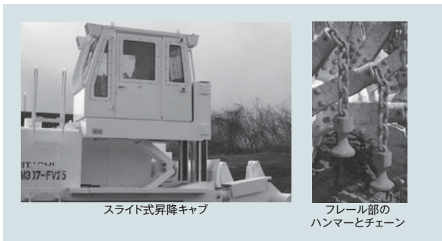
図5 | スライド式昇降キャブとハンマー・チェーン
