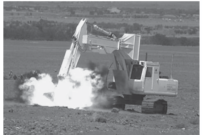
図3 | アフガニスタンで実施した耐爆評価試験
