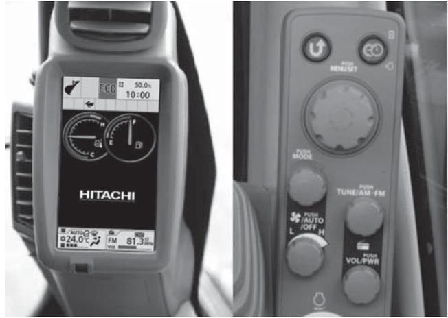
図7 | マルチモニタと操作装置
