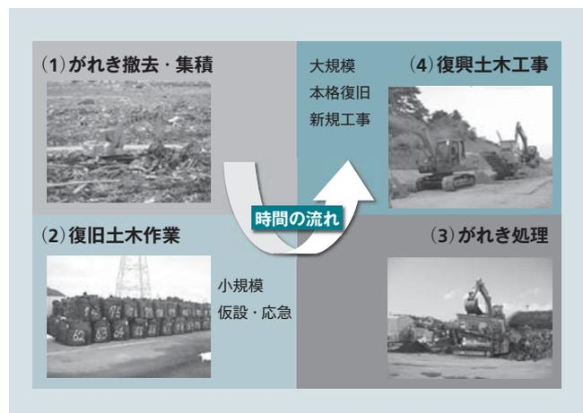
図1 | 時間軸から見た復旧作業・復興工事の流れ
