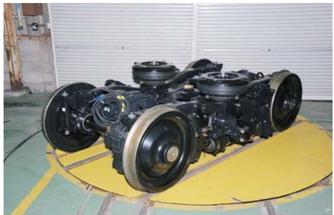
図9 | 軽量インナーフレーム台車の外観
