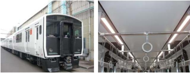
図1 | 九州旅客鉄道株式会社納め817系の外観および室内LED照明
