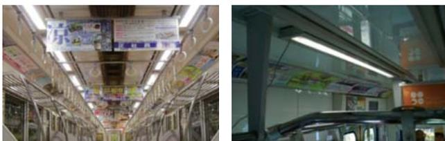
図5 京王電鉄株式会社納め8000系のLED直接照明タイプ（改造車）
