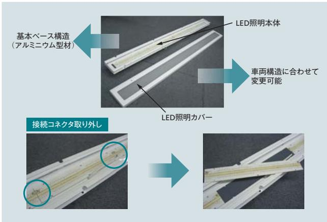
図3 LED照明構造およびLED基板
