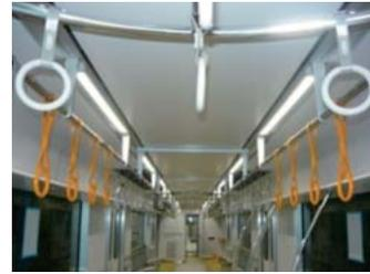
図6 九州旅客鉄道株式会社納め817系のLED直接照明タイプ（新造車）代表的なA-trainに搭載した室内天井構造を示す。シンプルで広い室内空間になっている。
