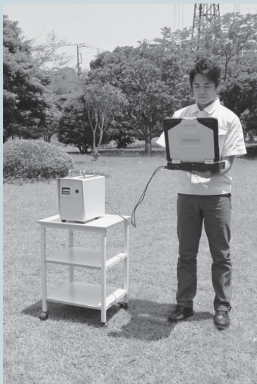
図1 | 放射線測定装置「ガンマカメラ」の外観と使用例
