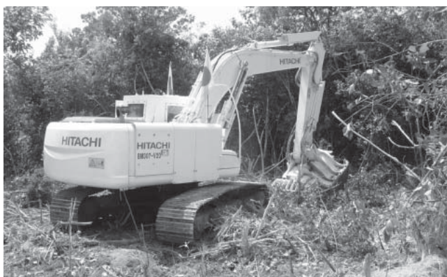
図1 | ロータリーカッターで効率よくブッシュを処理する旋回式対人地雷除去機 地雷を見つけやすくするため、ロータリーカッターで灌（かん）木を伐採して整地する。不整地や斜面など、地形の形状に合わせて旋回しながら除去作業を行う。
