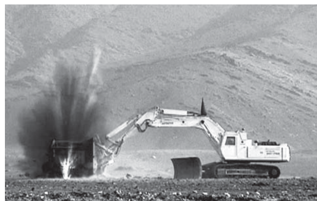
図2 | アフガニスタンで実施した耐爆評価試験
