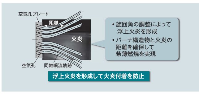
図11 多孔同軸噴流バーナ(クラスタバーナ)の特長 浮上火炎位置までに予混合燃焼器と同等の希薄混合気を形成し、低NOx燃焼を実現した。
