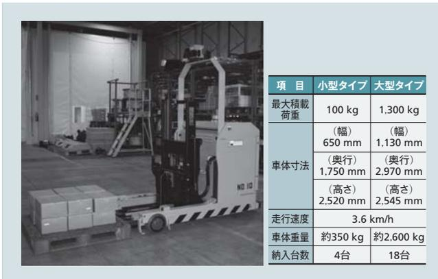
図2 | フォークリフト型「インテリジェントキャリア」の外観と主な仕様
