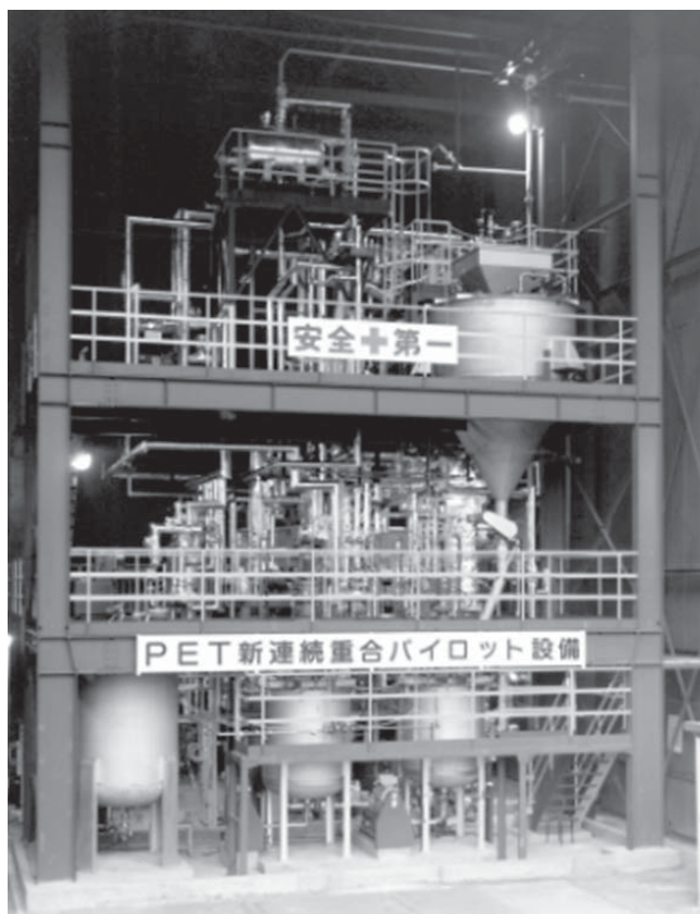
図4 日立プラントテクノロジーのパイロットプラント 連続式プロセスの実証が可能である。
