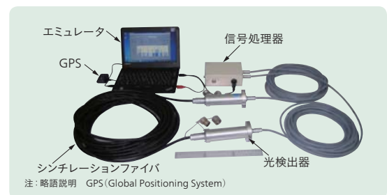
2 シンチレーションファイバを用いた線量当量率測定装置「D-phod」
