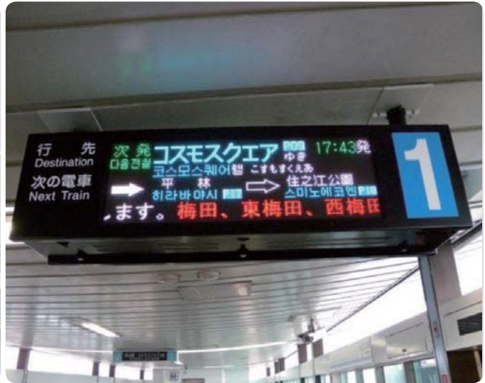
4 大阪市交通局 南港ポートタウン線のフルカラーLEDを採用した旅客案内表示装置
