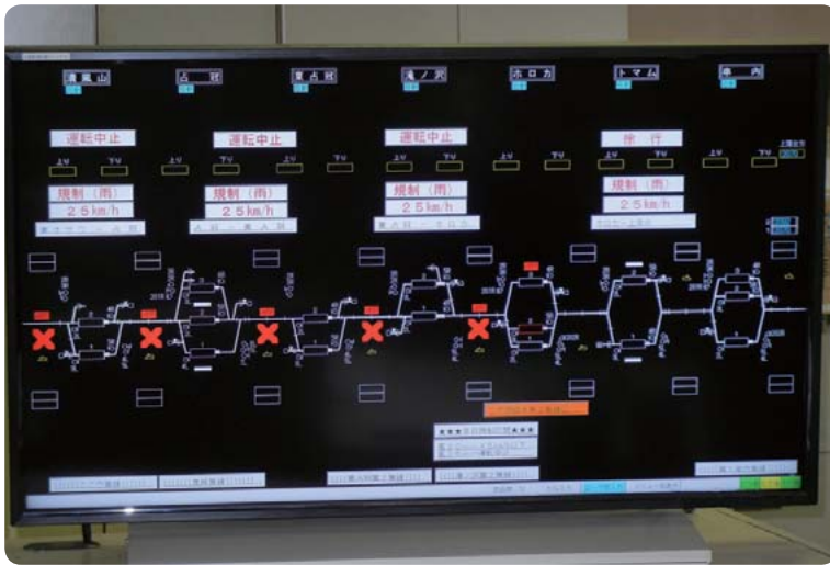
7 北海道旅客鉄道 石勝線運行管理システムの大型液晶モニタ（ピタネット貼付）
