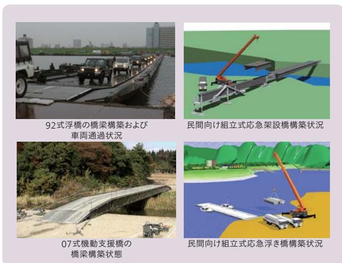
7 92式浮橋および07式機動支援橋の橋梁と民間向け応急橋梁
