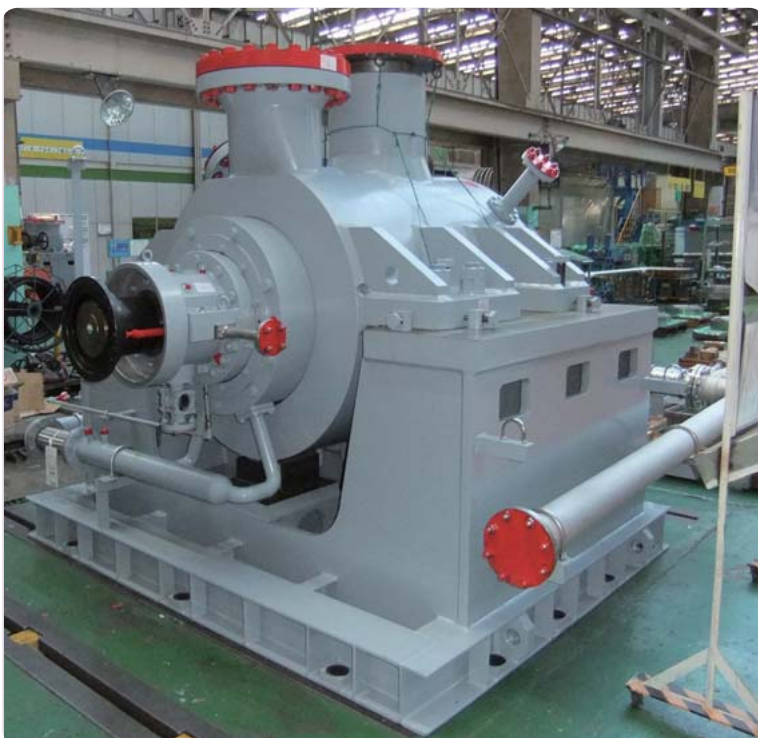
22 エジプト・アインソフナ超臨界圧火力発電所向けボイラ給水ポンプ
