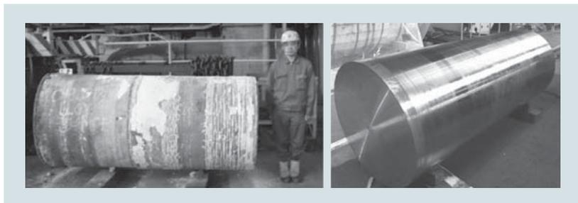
図4 | ニッケル基合金を用いて製造した大型鋼塊(左)と試作したタービンロータシャフト鍛造素材(右)
