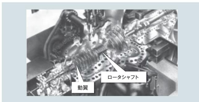
図2 | 蒸気タービンの模式図(高圧タービン)
