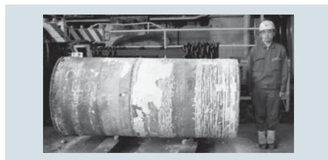
図4 | 開発材で試作した大型鋼塊
