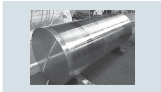
図5 | 開発材によって試作したタービンロータシャフト鍛造素材
