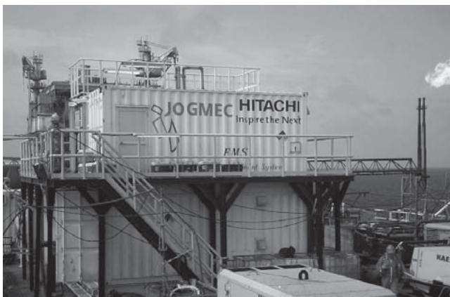
図10 | 海洋プラットフォーム上に設置した凝集磁気分離装置 メキシコ・カンタレル油田の海洋プラットフォーム上で現地実証した凝集磁気分離装置のパイロット機（日量1万バレル）の外観を示す。
