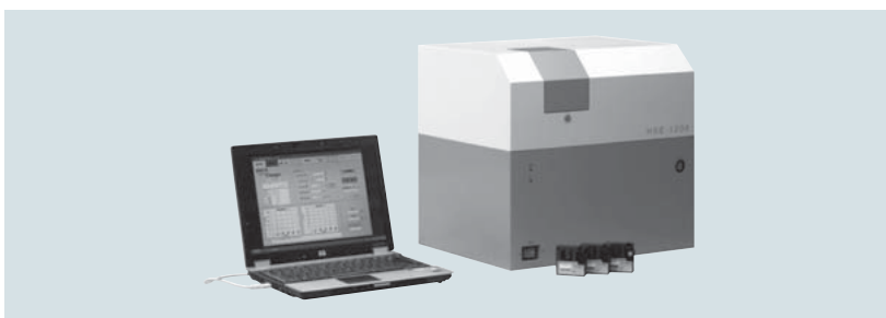
図7 | 細菌数の迅速計測装置「カセットラボONE」 カセット式の簡単操作、培養法を用いずに細菌数を計測、90分で迅速計測の3つの特徴を備えた卓上の細菌数迅速検査装置である。
