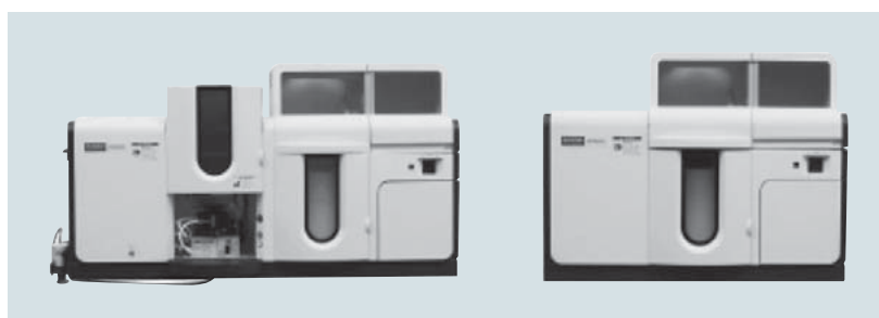
図5 原子吸光度計 フレーム・グラフィットファーンエス両用機「ZA3000」（左）と、グラフィットファーンエス専用機「ZA3700」（右）の外観を示す。
