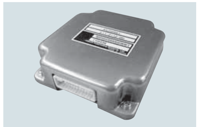
図2 | ADAS ECUハードウェアの外観
