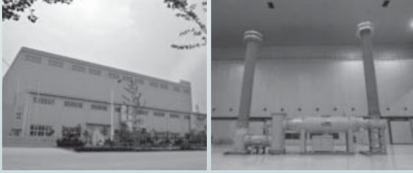
図2 | 山東電工電気日立高圧開閉有限公司(左)と超々高圧ガス絶縁開閉装置(右)の外観 超々高圧ガス絶縁開閉装置は、世界で初めての商用1,100 kV UHV交流送電プロジェクトに向けて開発されたものである。
