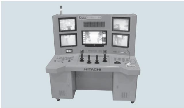
図10 | ASTACO-SoRa遠隔操作盤の外観
