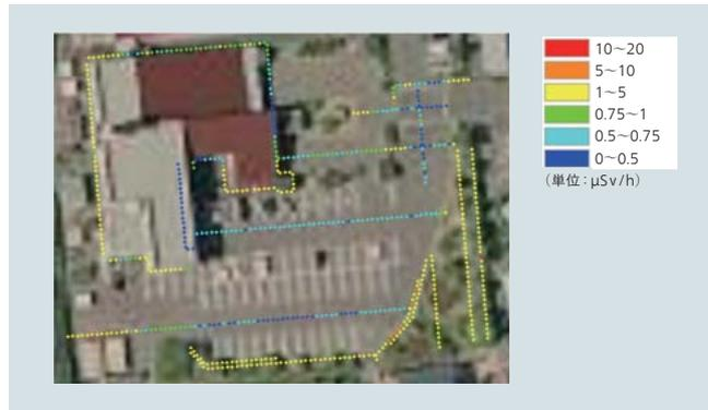
図4 | D-phodによる線量当量率測定例
