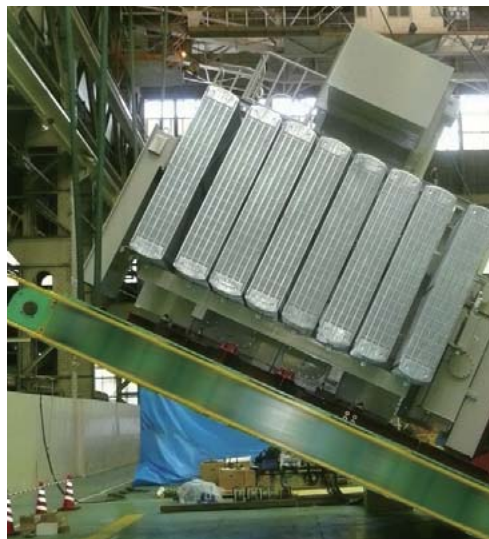
変圧器の傾き試験の様子。浮体の上に設置するため、揺れへの十分な対策が求められた。
