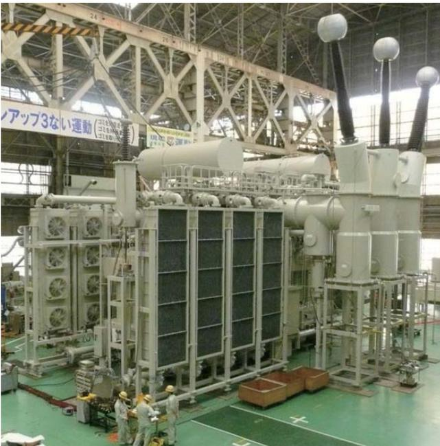
7 900 MVA級発電所向け変圧器1台目工場試験姿(4台納入)
