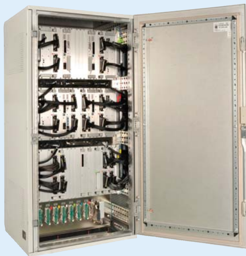
1 日立製ETCS車上信号装置とそれを搭載したClass 97機関車
