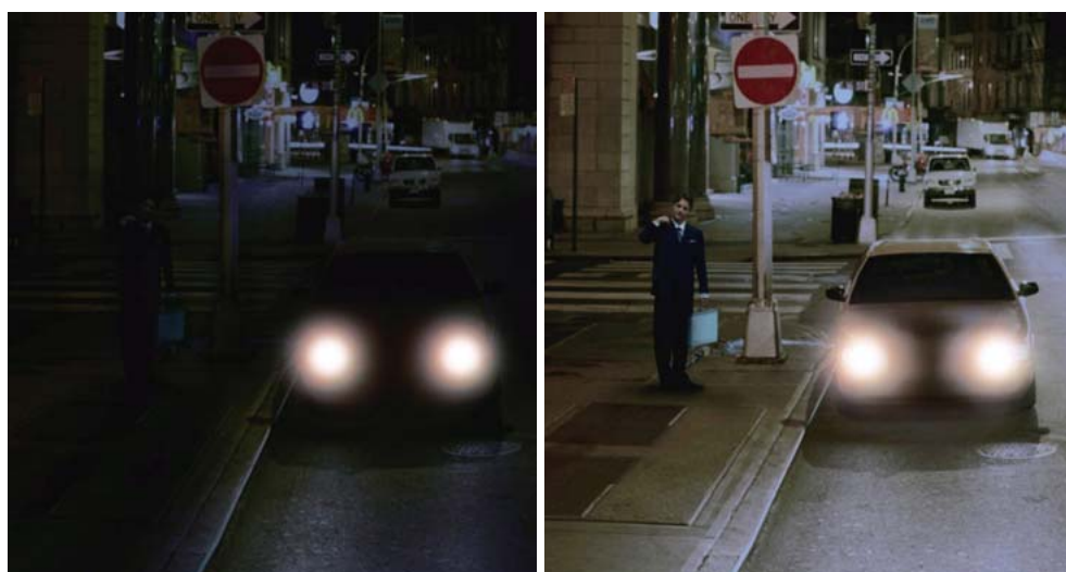
2 入力画像（左）とEnhanced Intensity機能による補正後の出力画像（右）の比較
