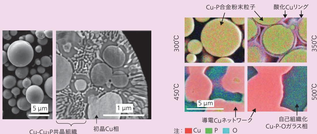
注：大気中焼成過程は、塗膜断面のSEM写真上に、エネルギー分散型X線分析によって得られた化学組成マップを合成して作図したものである。
