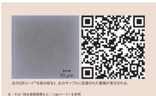
3 26層サンプルの13層目顕微鏡像 (左) と記録パターン (右)
