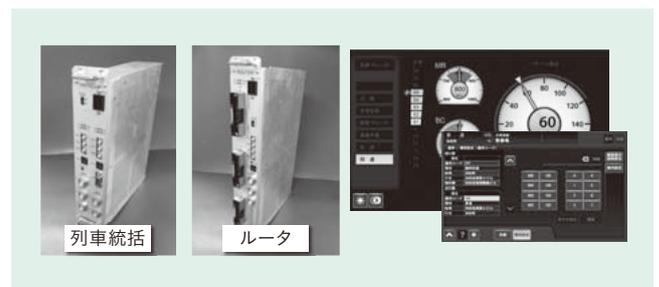
図10 | 装置外観および運転台表示
