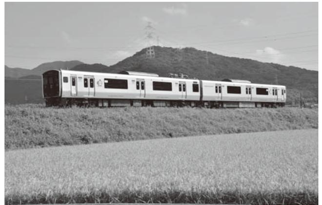
図3 | 蓄電池試験電車の外観
