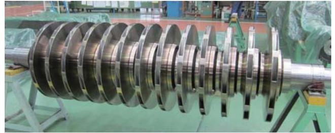
26 13枚の羽根車を有するコンプレッサロータ
