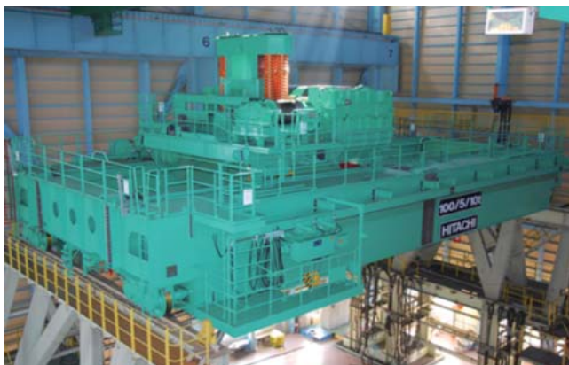
7 福島第一原子力発電所4号機燃料取出・移送用クレーンの製作工場内試験の様子（オレンジ色のものが緩衝ばね装置）
