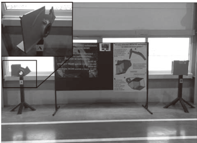
図9 | 溶接カットモデルの工場内展示 高度な耐久性が求められるフロントアタッチメントの一部を切り出し、接合の正確性を目視確認できるように展示している。
