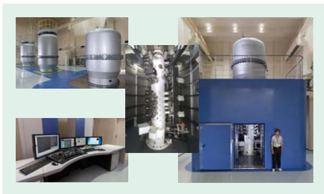
図11 | 原子分解能・ホログラフィー電子顕微鏡
