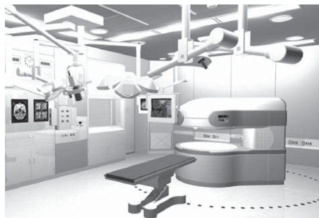
図2 | MRIを術中撮像システムとして構築したイメージ図 オープンMRIを備えた脳外科手術室の例を示す。床の破線は0.5 mT（地磁気の約10倍）である磁場安全管理区域を示している。この外側では通常の手術器具を使用することができる。
