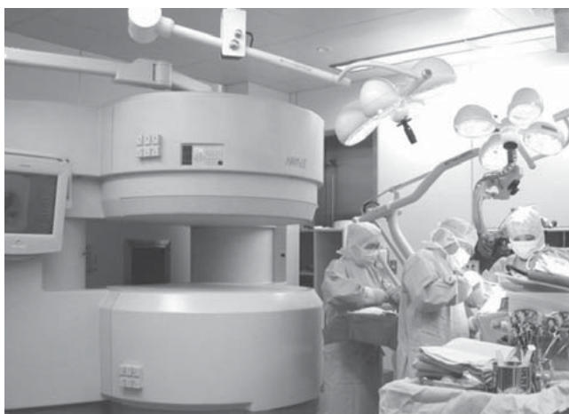
図1 | 手術室設置MRIシステム（提供：東京女子医科大学病院） 磁場の漏えいが少ない永久磁石MRI（Magnetic Resonance Imaging）により、MRI近傍での脳外科手術が可能となった。
