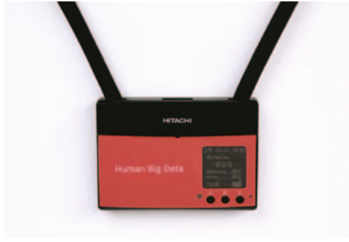
ヒューマンビッグデータの収集に用いられる名札型ウェアラブルセンサー。身体の動きに関するデータを計測し、業務生産性や従業員満足度の向上に活用する。
